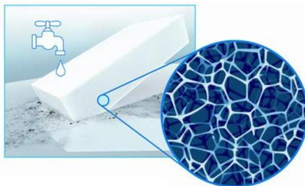
Grande capacité d'abrasion grâce aux aspérités pointues des nombreuses microcellules.
